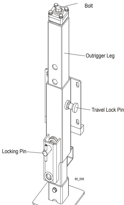
**FIG. 2-16. ADJUSTABLE OUTRIGGER.**
