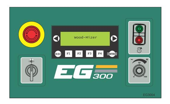
FIG. 3-5 EG300 CONTROL PANEL COMPONENTS (U.S ONLY)
